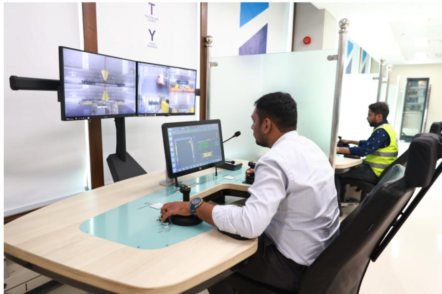
“遙距操作的吊機允許操作員在空調室內環境中遠程作業，從而大大減低他們在極熱環境中暴曬的機會。”
